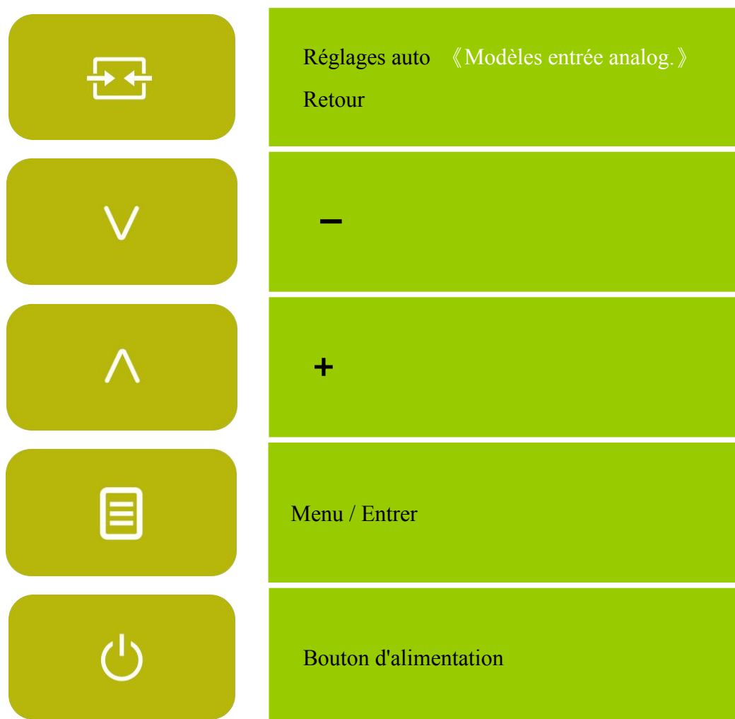
Figure.4. Boutons du panneau de commande
